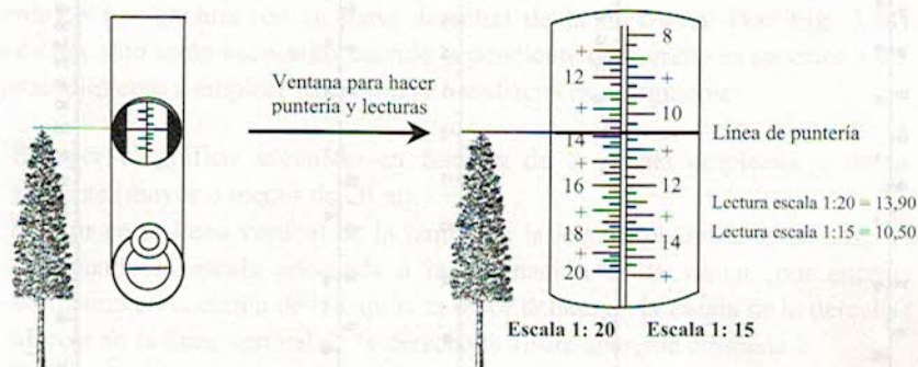
Figura 3.32. Ejemplo de visualización al ápice para medir la altura de un árbol con el hipsómetro Suunto.
