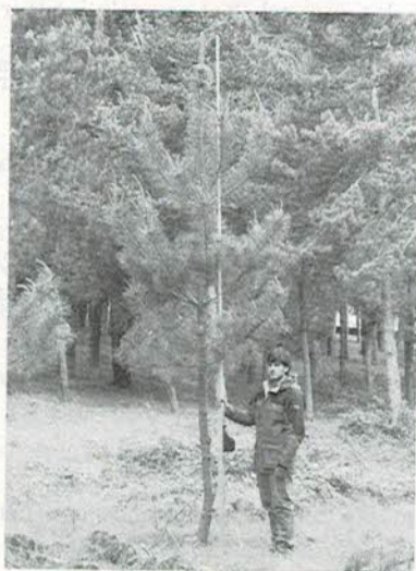
Figura 3.9. Medición de la altura total de un árbol con pértiga telescópica (izquierda) y detalle del lector de la pértiga (derecha).
