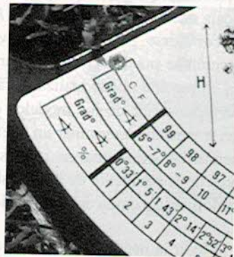
Figura 3.28. Arriba y abajo a la izquierda, aspecto del hipsómetro Blume-Leiss modelo BL-8 (con una aguja y visor dióptrico). Abajo a la derecha, detalle del factor corrector de la altura cuando se ha medido la distancia horizontal al árbol con ayuda del visor dióptrico y su mira en un terreno en pendiente.
