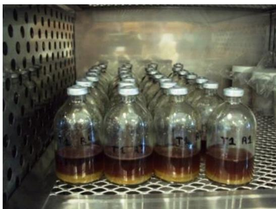
**Figura 7.** Biodigestores utilizados para la determinación de la degradabilidad ruminal.
