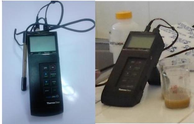
**Figura 5.** Potenciómetro utilizado para medir pH.
